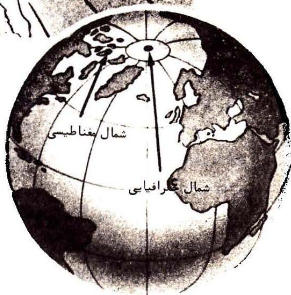
قطبهای شمال و جنوب مغناطیس و جغرافیایی همواره نسبت به هم در نقطه‌های معینی قرار نمی‌گیرند.
